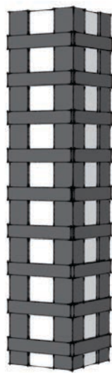
■ Ograđivanje komprimiranih polustupova metalnim kutnicima i ravnim elementima
